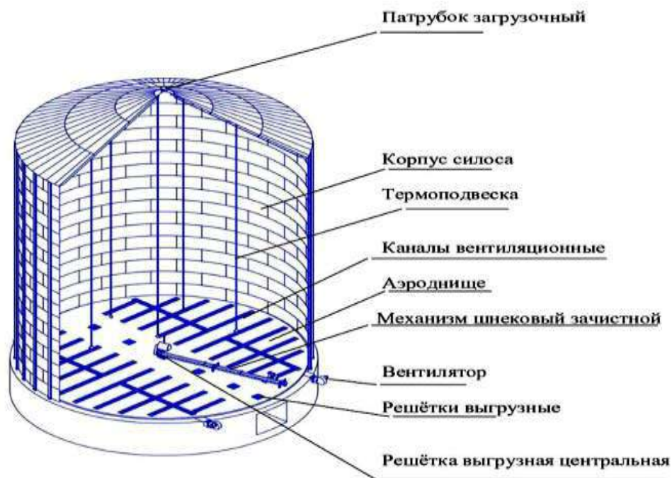
Рисунок 1 – Конструкция силоса
